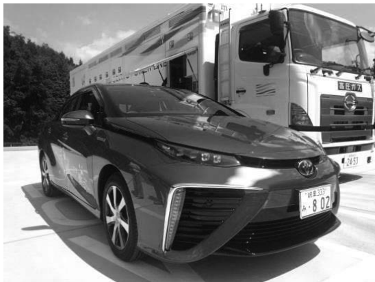
ミライ (移動式水素ステーションからの補給風景)
