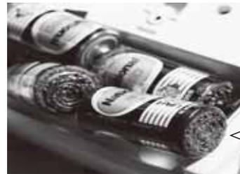
電池の液漏れにより、電池ボックスが腐食し、接触不良になってしまった戸別受信機
