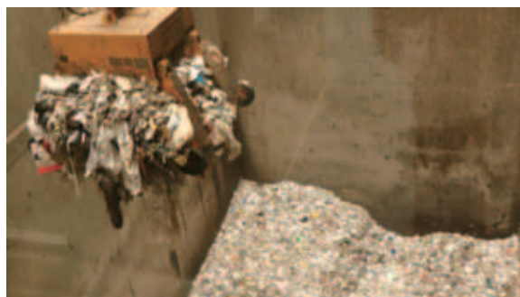
ごみピットの様子。可燃ごみはここに集められてから焼却されます。
