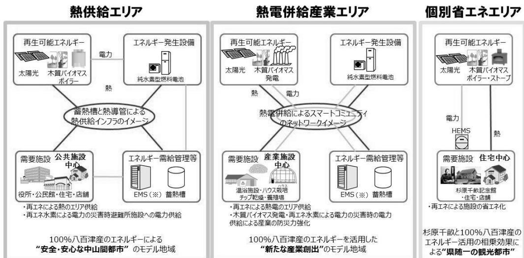
(※)EMS(エネルギー・マネジメントシステム)とは、需給管理装置のことをいいます。この装置は、施設(建物)内の電力を最適に分配するために制御・管理を自動で行います。また、太陽光発電システム等で蓄えた電力のうち、余った分や不足した分に対して充電や供給を自動で行いエネルギー利用の無駄を減らします。家庭で使用する需給管理装置はHEMS(ホームエネルギーマネジメントシステム)といい、家電や電気設備とつなぐことで家電機器の自動制御のほか、電気やガス等の使用量をモニター画面等で確認することもできます。
